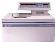
Ультрацентрифуга OPTIMA MAX - напольная и настольная лабораторная центрифуга. В основном ультрацентрифуги применяются для разделения и выделения белков, липопротеинов, плазмид ДНК, РНК, субклеточных органелл и вирусов.
