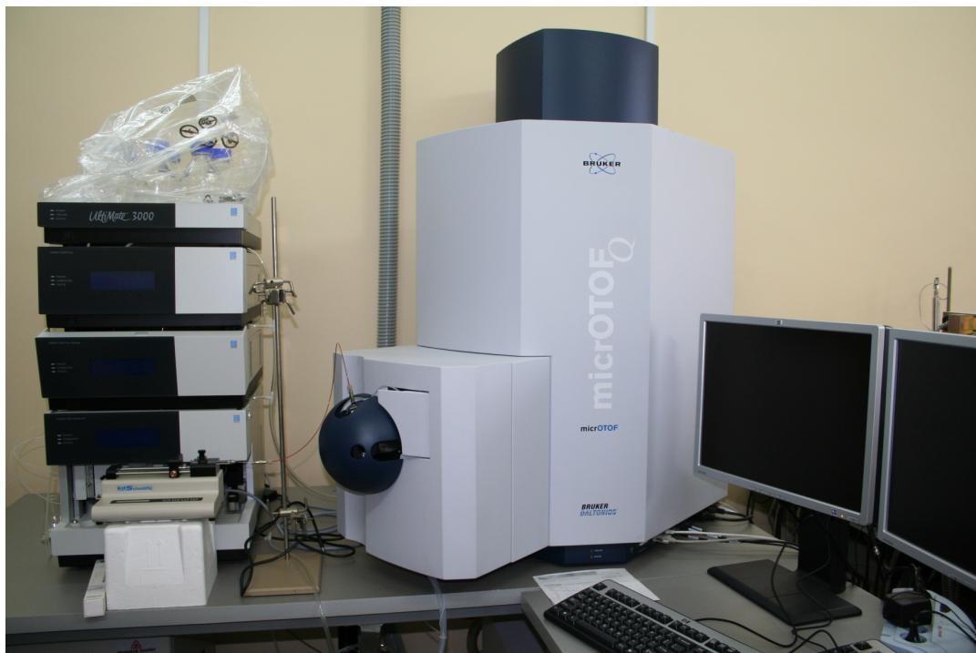
**MC/MC производительность** Сочетая уникальные особенности времяпролетного масс-спектрометра micrOTOF - отличную точность определения массы и превосходную разрешающую способность, превышающую 17,5000 - с возможностью получения MC/MC данных, micrOTOF-Q II позволяет проводить de novo секвенирование пептидов и даже определение пост-трансляционных модификаций. Надежность результатов протеомных исследований гарантируется точностью определения молекулярных масс и структурным анализом малых молекул.
