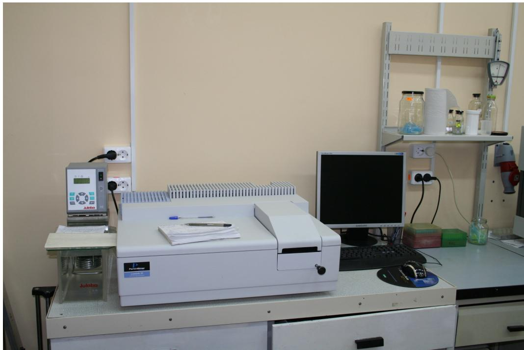
Спектрофотометр серии **Lambda 25** – двухлучевой сканирующий УФ/Вид спектрофотометр для рутинных и автоматических измерений. Этот прибор предназначен для различных промышленных, учебных, биологических и биохимических лабораторий и лабораторий по контролю окружающей среды. Он отличается высокой стабильностью, гибкостью в выборе методов анализа, удобством представления и обработки полученных данных.
