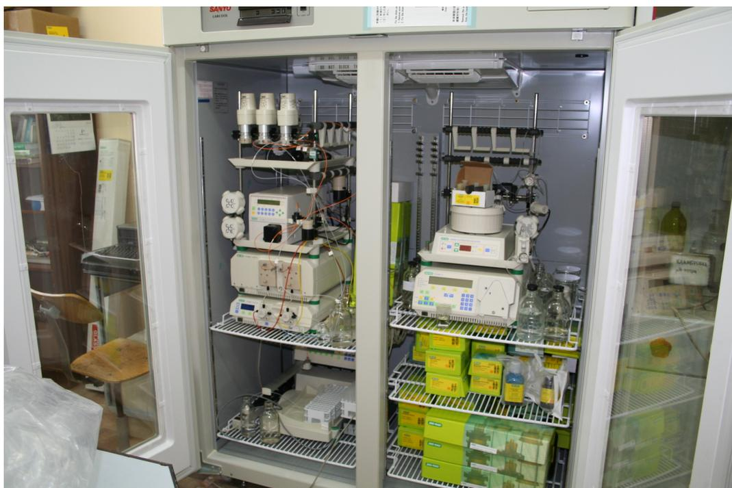
Хроматографическая система **BioLogic LP** позволяет работать со скоростями потока не более 20 мл/мин на канал при давлении 0,2 МПа и может использоваться как в учебных, так и научных лабораториях. Хроматографическая система позволяет осуществить первоначальное разделение больших объемов многокомпонентной смеси, а также разделение рекомбинантных белков при помощи аффинной хроматографии.
