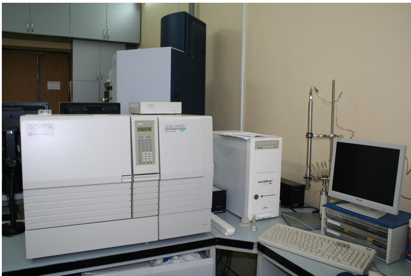
Гибкий квадрупольный газовый хромато-масс-спектрометр наряду с ионизацией электронным ударом (EI) и системой положительной химической ионизации (PCI) для высокоточного определения молекулярной массы имеет также систему отрицательной химической ионизации (NCI) для высокочувствительных анализов электрофильных соединений.
